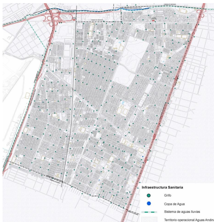
Figura 37 Plano infraestructura sanitaria en Pedro Aguirre Cerda
